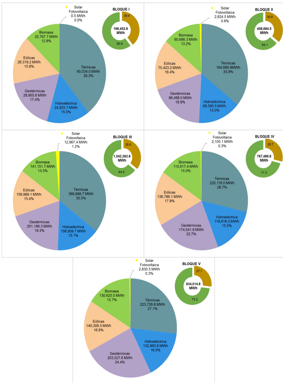
Gráfico 23 Inyecciones Eléctricas por Bloque Horario (MWh) Año 2020
